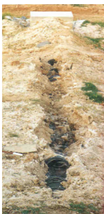
Фиг. 10: пожар в тръба от полиетилен с висока плътност (HDPE) в южна Австралия
