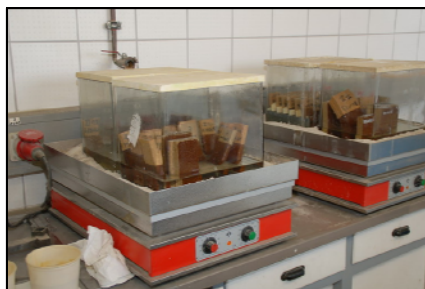
Фиг. 7: процедура на изпитване на проби от глазирана керамика : 15% H_2SO_4 в продължение на 200 дни при T=50^\circ C
