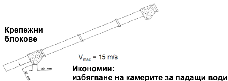
Фиг. 9: спестяване на средства при използване на глазирана керамика в комбинация с големи наклони
