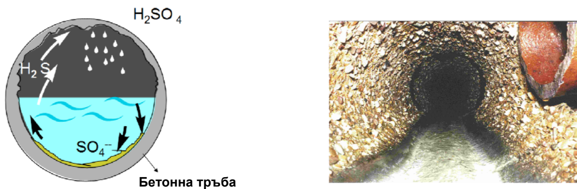
Фиг. 6: цикъл на биологична корозия и пример за корозирала канализация. Забележети глазираната керамична тръба: в идеално състояние въпреки неправилния монтаж.
