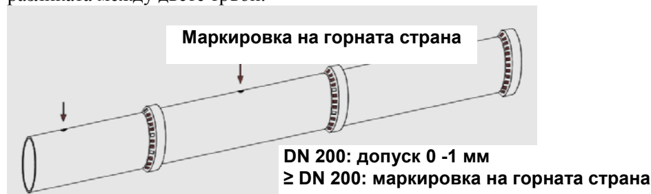
Фиг. 13: всяка тръба има маркировка на горната страна
